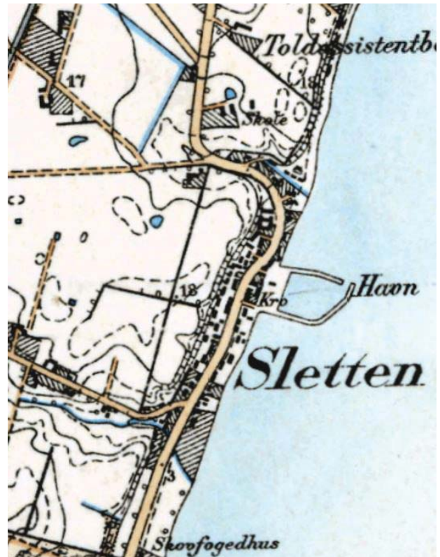
Udsnit af Høje Målebordsblade, der viser hvordan adgangsveje fra nord og syd har kunnet føres gennem erosionsdale i stedet for via den stejle kystskrænt, og derved medvirket til at gøre placeringen ideel.
